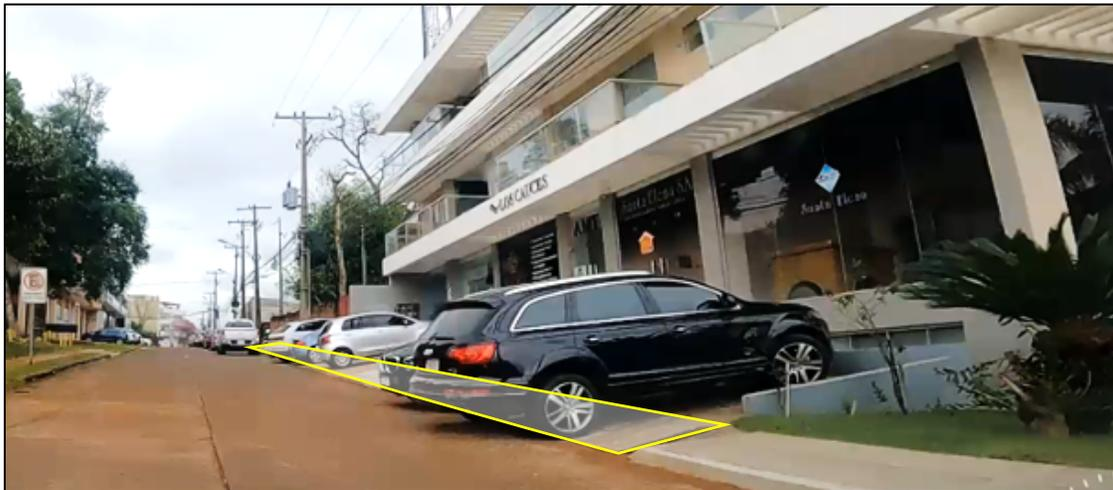
*Figura 20 - Ancho de vereda no es suficiente para acomodar vehículos, bloqueando las veredas*
