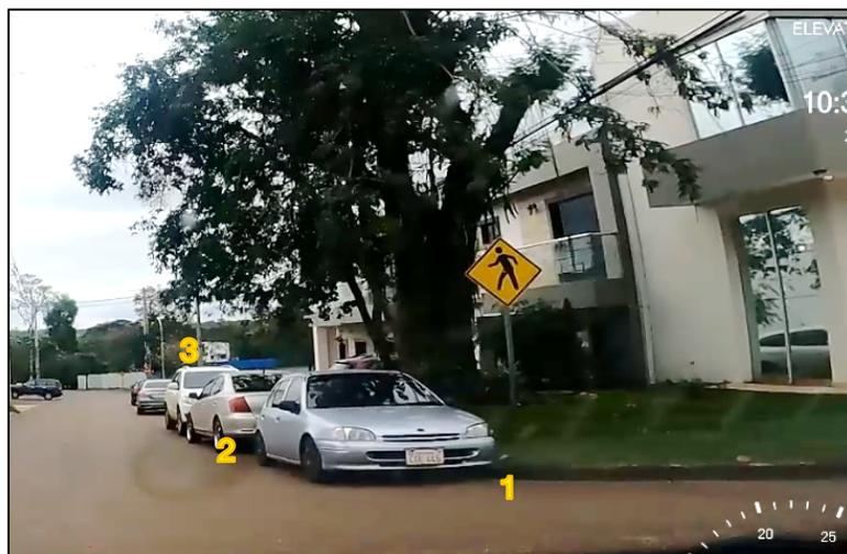
Figura 19 - Estacionamiento Informal/Ilegal: estacionamiento en la esquina (1), bloqueando salida de vehículos (2), estacionados en ambas las direcciones (3).
